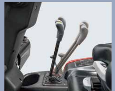
Die Abdeckung kann leicht geöffnet werden, indem die Pegel nach vorne eingestellt werden
