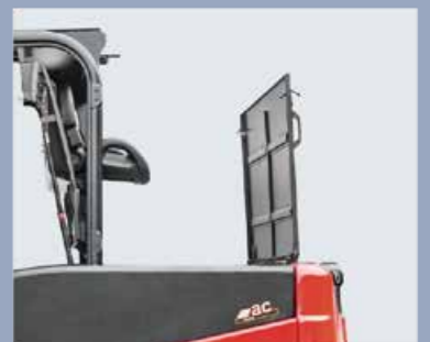
Die vollständig geöffnete Batterieabdeckung erleichtert die Wartung der Batterie
