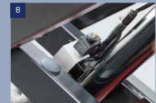
Explosiongeschütztes Ventil: Um zu verhindern, dass die Maschine herunterfällt, wenn die Ölleitung undicht ist
