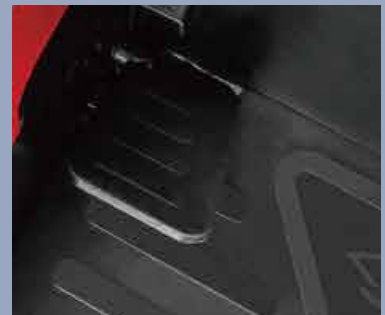
Sicheres Pedal: Wenn das Pedal losgelassen wird, wird die Fahrt gestoppt und nur der Hydraulikbetrieb aktiviert
