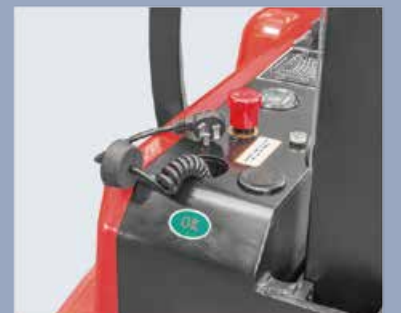
Eingebautes Ladegerät und wartungsfreier Gel-Akku sorgen für eine bequeme Nutzung
