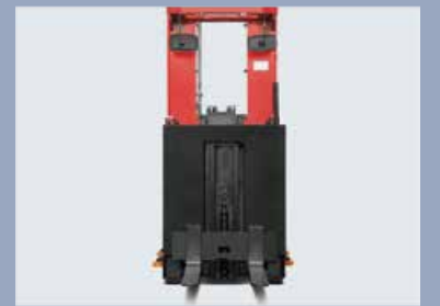
Zusatzlift auf Bedienerplattform. Die Palette kann zum Kommissionieren auf die bequemste Arbeitsebene angehoben werden
