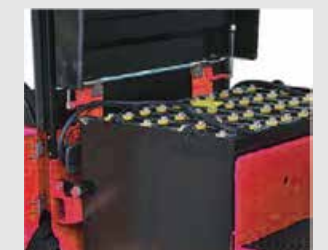
Die Batterieabdeckung kann vollständig sein geöffnet, ist das Design wartungsfreundlich
