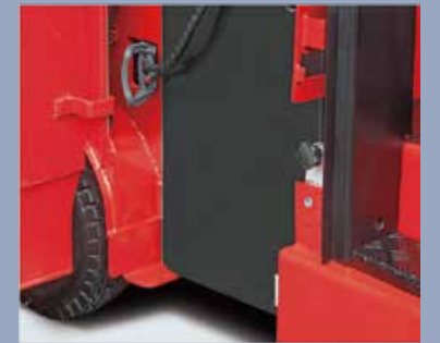
Die Batterie kann aus dem LKW entfernt werden, so ist es sehr praktisch für die Batterie Instandhaltung
