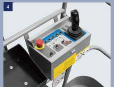
Korb-Steuerbox: Jede Aktion des Geräts kann über die Steuerbox gesteuert werden, um schnell zum Arbeitsbereich zu gelangen. Die Steuerung ist einfach und leicht zu verstehen
