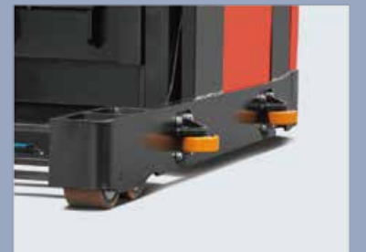
Schieneführungsrollen (opt.) Können für VNA-Arbeiten am LKW montiert werden
