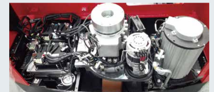
Bei vollständig geöffneter Pedalstruktur sind die elektrischen Teile vollständig freigelegt, was für die Wartung praktisch ist
