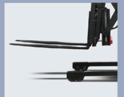
Proportional gesteuerte Gabeln können genauer betrieben werden
