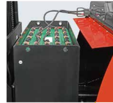
Batterie kann vorwärts entfernt werden
