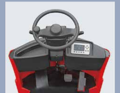
Verschiedene Betätigungspedale, Instrumente, Lenkrad und Schalter werden je nach ergonomischen Anforderungen konfiguriert und sind komfortabel und flexibel zu bedienen
