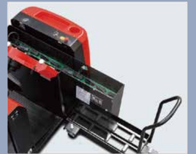
Seitenbatteriewechsel sind Standard
