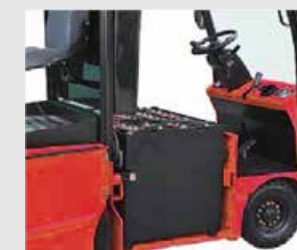
Seitenwechsel Batterie Design ist praktisch zum Batteriewechsel
