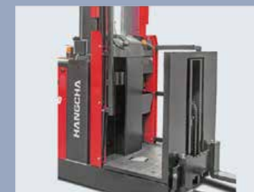
Die Kommissionierung funktioniert nur, wenn alle Seitenbarrieren abgesenkt sind
