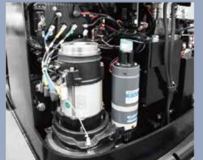
EPS (Electric Power Steering) ist Standardspezifikation
