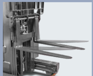
Gabeln können leicht nach vorne / hinten gekippt werdenloading
