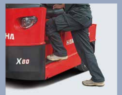
Das weit geöffnete Trittbrett mit niedrigem Niveau ist für den Bediener sehr bequem, um in den LKW ein- und auszustiegen
