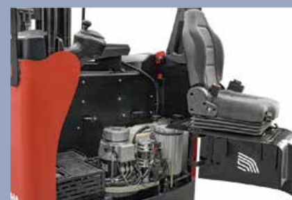
Die vollständig geöffnete Tür ermöglicht eine einfache Reparatur und Wartung
