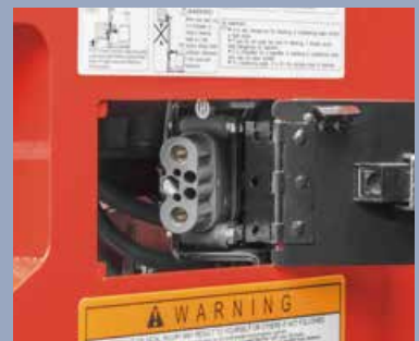
Durch den Ladestecker im Fahrerhaus muss der Stecker nicht mehr von der Batterie getrennt werden, was die Bedienung erleichtert (Standard).
