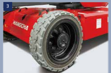
Reifen: schaumgefüllte Reifen mit guter Geländeleistung
