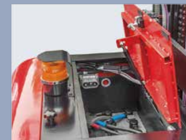
Die hintere Motorhaube kann leicht entfernt werden, um Wartungsarbeiten an Teilen wie Hydraulikeinheit, elektronischem Steuerungssystem und Motor zu erleichtern
